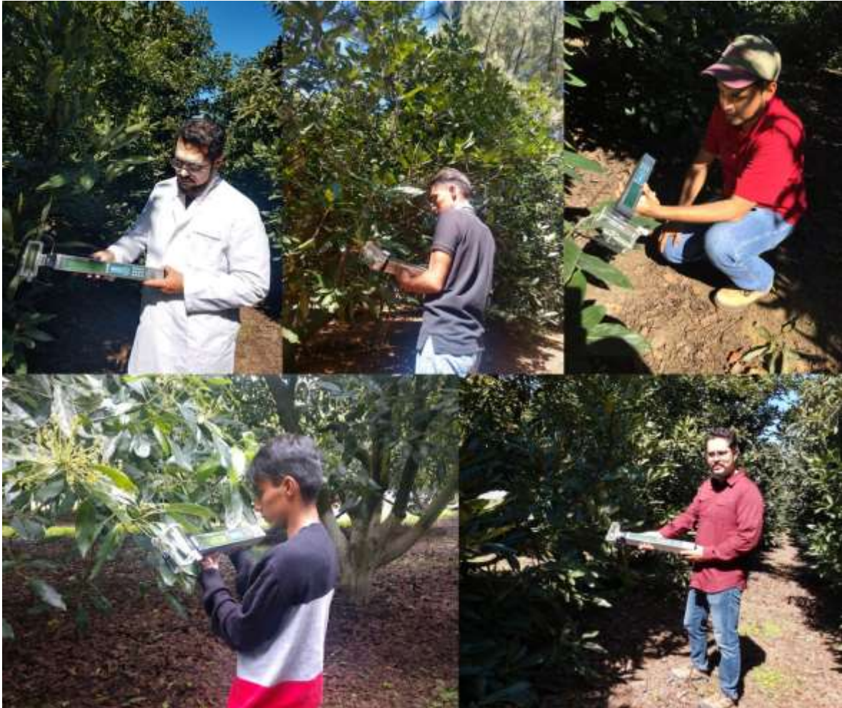
Figura 34. Determinación de intercambio de gases mediante sistema portátil al infrarrojo.
